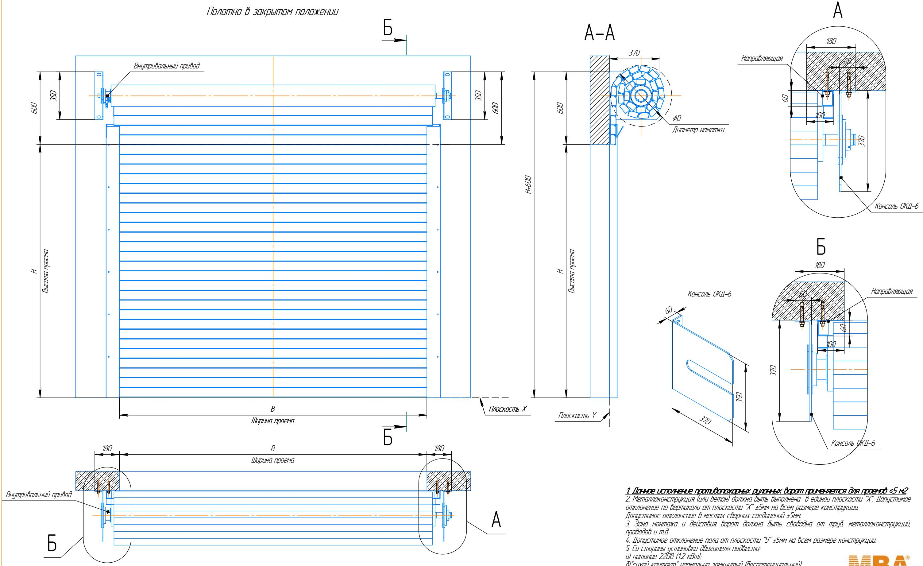
Рулонные противопожарные ворота "Firerollgate-E160" (наполнитель минеральная вата)
